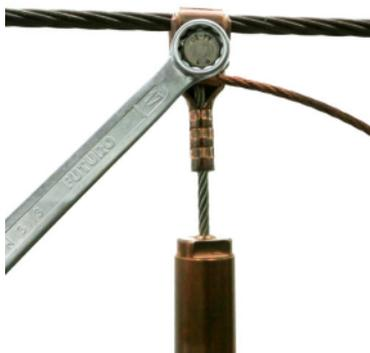
2. Befestigen der verpresst gelieferten Seilhängerklemme am Tragseil. Anziehen der Schraube mit 25 Nm.
