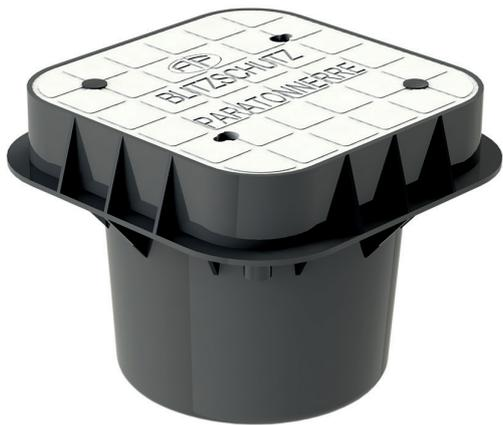
Die Bodendose ist für den Einbau im Aussenbereich (Erdreich, Pflastersteine oder Beton) auf privatem Grund nach EN62561-5 bestimmt. Entsprechend der Bettungsart Erdreich, Kies, Beton **a** – ist die Belastbarkeit max. 5000 kg.
