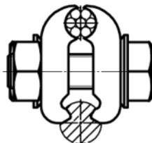
1. Muttern entfernen und Schrauben lösen.
