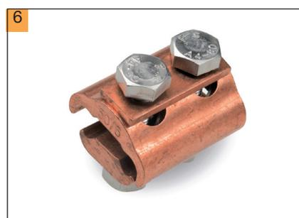
Verbindungen von Erdleitern müssen Kurzschluss- und Blitzstosströme durchleiten und können deshalb nur mit Klasse-H geprüften Verbindern ausgeführt werden. (siehe dazu Handbuch «Äusserer Blitzschutz»)
