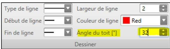
Avec l'outil de conception RED CAD Flury, il est possible d'entrer le matériel d'installation. Afin de saisir correctement la longueur du dispositif de capture, il convient de régler l'inclinaison de la toiture en cas de toits inclinés.
