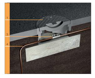
Entrée du conducteur verticale par l'ouverture du plancher. Pour une installation en extérieur selon la norme EN62305-3.
