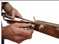
13. Ajuster les patins (pousser manuellement vers le haut) et serrer les écrous avec 40 Nm.
