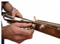
13. Regolare le sciabole (spingere manualmente verso l'alto) e serrare le viti a 40 Nm.
