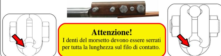
8. Serrare solo le viti con la chiave dinamometrica a 50 Nm per 3 volte.
