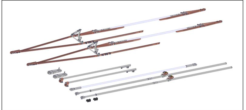
Den Streckentrenner auf einer ebenen Unterlage zusammenstellen. Die Schrauben mit **25 Nm** anziehen.
